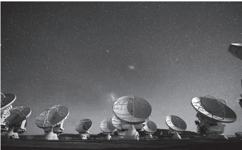
La scelta delle onde radio è quasi obbligata perché queste riescono ad oltrepassare i gas e le polveri che si frappongono sulla linea di vista e al tempo stesso offrono una risoluzione angolare altissima, cioè permettono di vedere molto lontano. In particolare si è scelto di utilizzare una lunghezza d'onda di 1,3 mm (corrispondenti alla frequenza di 230 GHz).
